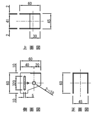
照明取付金具詳細図 S=1:5 ボール用 (SUS2B・塗装仕上)
